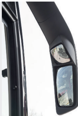
Ein moderner Bus ist nach Möglichkeit mit zweifachem Spiegelsystem auszustatten.
