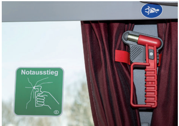
gekennzeichnete Notausstieg mit Nothammer
