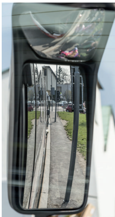
Kinder vor dem Bus und im Haltestellenbereich werden erst durch ein derartiges Spiegelsystem sichtbar.
